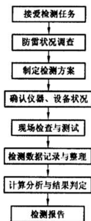
图 1 防雷装置检测工作程序框图
